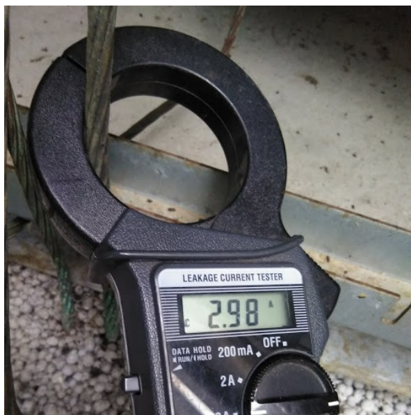
Illustration 3: Første måling viser strømforurening fra et af fire jordingskabler i en 900KW vindmølle. Bemærk dog at ståltårnet er boltet til et jordforbundet fundament med ca 50 bolte. Den samlede afledning til jord er omkring 100 ampere. Næste måling (på 9,38 Ampere) viser lækstrøm fra en transformator. Måling lavet i samarbejde med Vagn Larsen, Feltfri.dk
