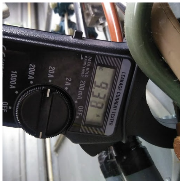
Illustration 3: Første måling viser strømforurening fra et af fire jordingskabler i en 900KW vindmølle. Bemærk dog at ståltårnet er boltet til et jordforbundet fundament med ca 50 bolte. Den samlede afledning til jord er omkring 100 ampere. Næste måling (på 9,38 Ampere) viser lækstrøm fra en transformator. Måling lavet i samarbejde med Vagn Larsen, Feltfri.dk
